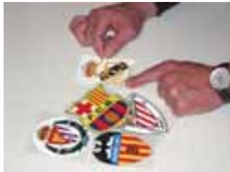
Echenillez l'excès de vinyle pour obtenir un autocollant ou une étiquette réalisée selon les désirs du client. Forme, taille et quantité sont modifiables à souhait.
