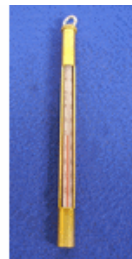
Thermomètre à rail Mesure la température des rails. Corps alu Graduation de -20°C à +60°C Longueur : 150 mm Poids : 200g
