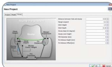
Fig. 2 - Paramètres de détourage du die
