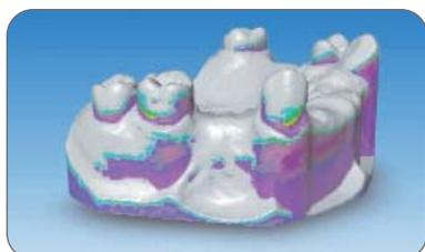
Fig. 4 - Comblement automatique des contre-dépouilles
