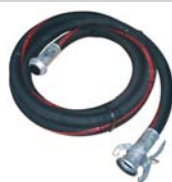
Tuyau à matériaux Ø 65 mm avec raccords Perrot (limite de pression : 10 bars)
