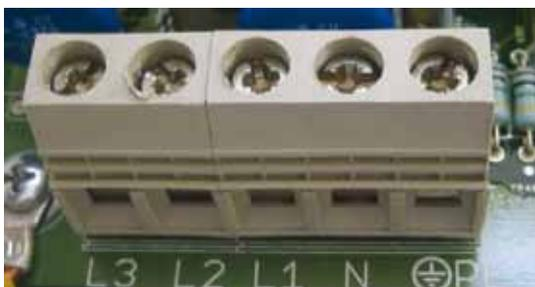
Figure 8.4 : **Raccordement électrique**
