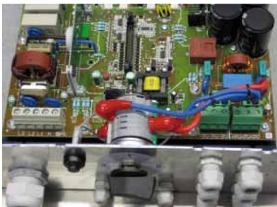
Figure 6.3 : **Compartiment de raccordement du Powador**
