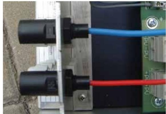
Figure 6.4 : **Montage des douilles Tyco**
