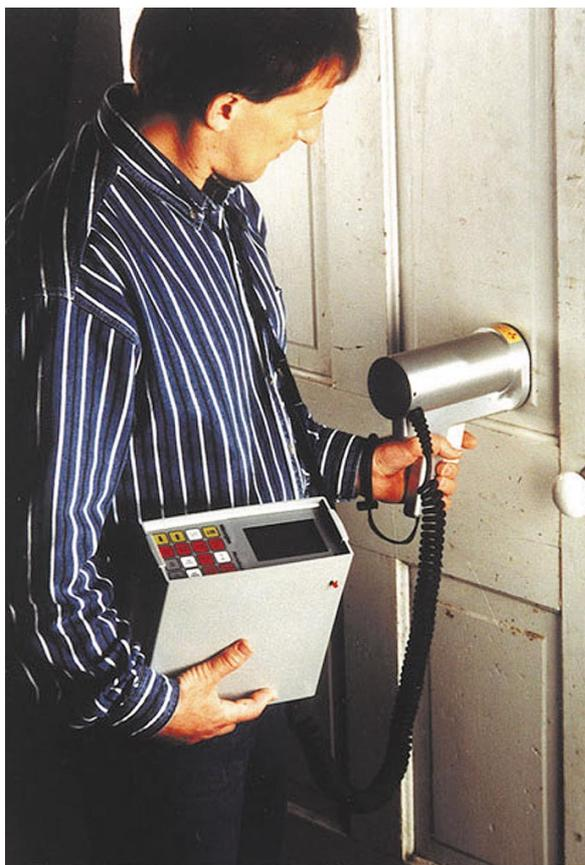
Mesure rapide sur site, de la teneur en plomb dans le revêtement d'une porte avec le Microlead 1
