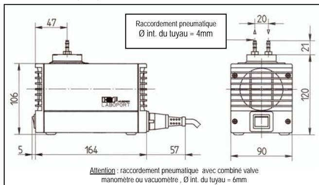
Tolérances des dimensions suivant DIN ISO 2768-1, classe de tolérance V
