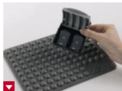
Grâce à l'effacement intégré, les écrans à mémoire peuvent être réutilisés immédiatement
