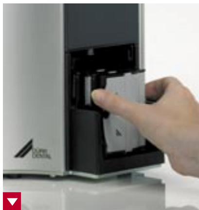
Le système de transport entièrement automatisé présente les écrans à mémoire, lus et effacés, dans la cassette.
