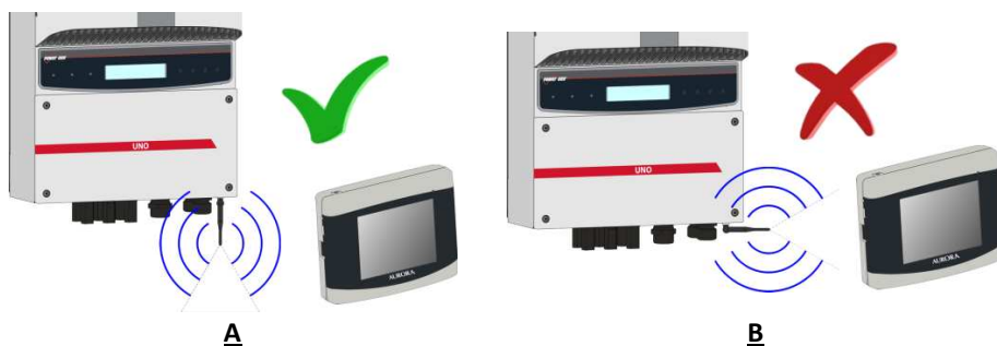
Figure 8 – Position réciproque de l'antenne et du PVI-DESKTOP a. réception optimale b. réception faible
