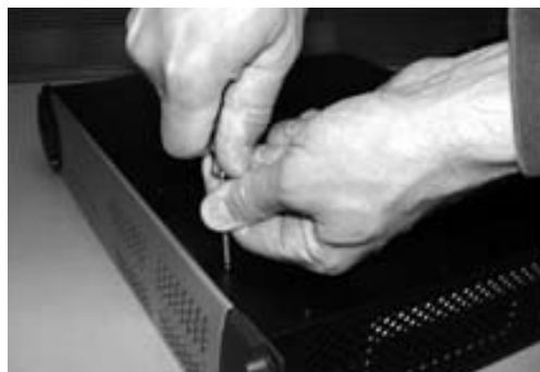
Retrait des vis du panneau supérieur
