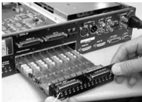
Insertion de la carte dans la baie, en soulevant légèrement la carte
